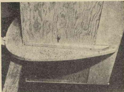
3 - La vista del rovescio del fondo del divano mostra una delle gambe ricurve ed una delle guide triangolari. Notate nella guida il foro destinato a ricevere lo spinotto del carrello.
